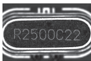
从低角度照射，可观察刻印字符。
